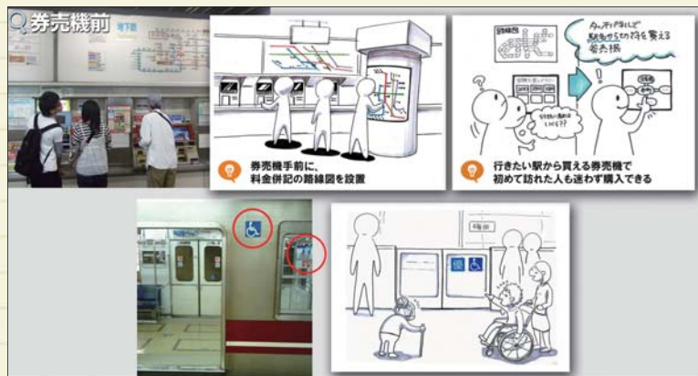
図3 (上) 動線に沿った運賃表の設置/券売機のタッチパネル工夫 (下) ホーム柵は、優先位置などサイン表示として活用
